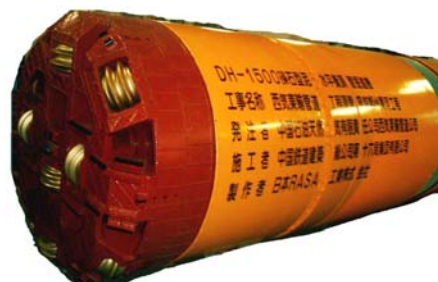
西气东输穿越黄河顶管工程 (卵石·岩盘型)
