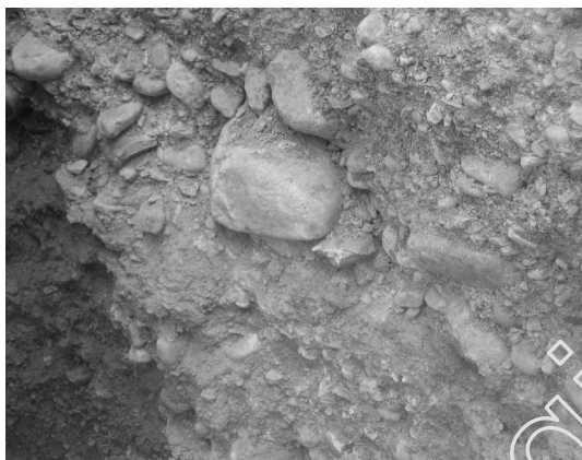
图2 顶管时的软硬地层
