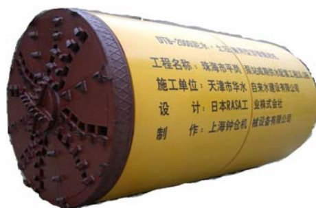
澳门-珠海引水工程 (泥水·土压兼用型)
