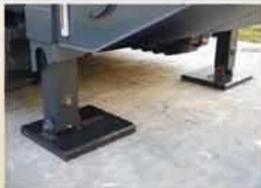
■ 更大接地面积的支腿脚板，全封闭行走马达设计，特别适合于松软地面条件下作业
