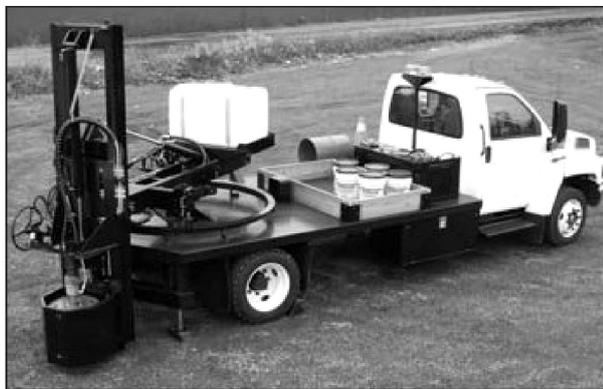
图 26 Utilicor 公司的路面取芯钻机
