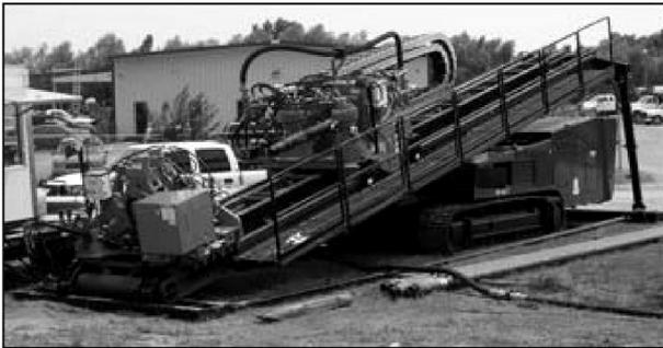
图 3 奥格公司的齿条齿轮型 DD—440T 定向钻机
