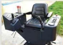
■ 符合人机工程设计的操纵台，仪表集中布置，操作轻便、舒适
