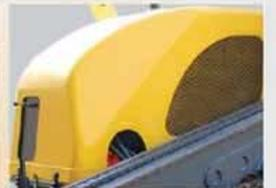
■ 可倾翻的整体玻璃钢机罩方便机器的维护、保养，流线形体具有良好的后视性能
