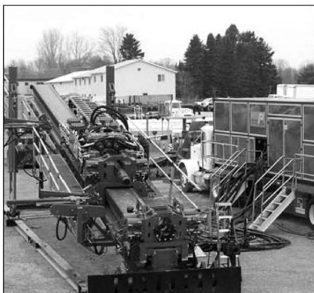
图 18 Mears 公司的水平定向钻机
