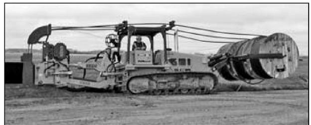
图 5 Avertex Utility Solutions 公司的地下集成电缆安装系统
