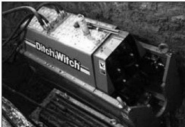
图 7 管线爆破系统
