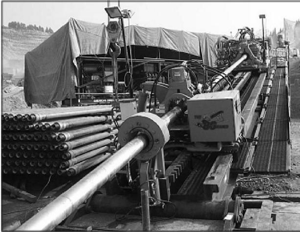
图 1 InterCon 公司在俄亥俄州穿越使用的 American Augers DD-1100 型钻机
