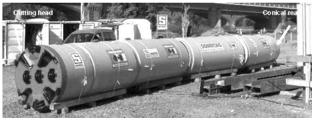
图 3 推进机 AVN1000XC 正准备铺设 48"管道
