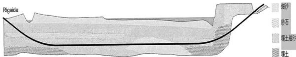
图 1 HDD 钻进横截面图
