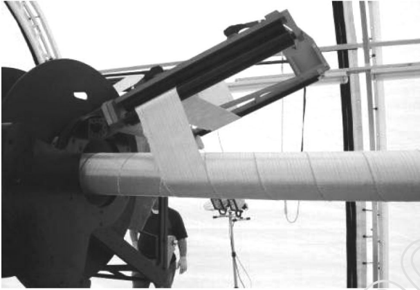
图 2 在聚合物芯管对应螺旋缠绕高强度重量轻的织物的方式——适合紧密配合修复长的老龄退化管道
