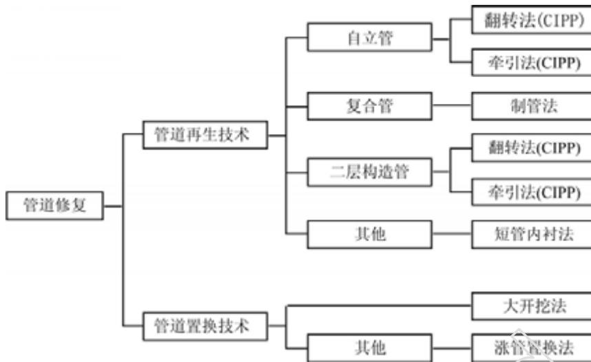
图1 管道修复技术的分类图
