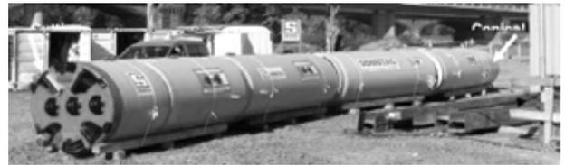
图8 用于铺设48"管道的直接铺管机 AVN1000XC
