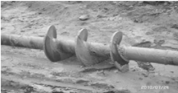
图2 螺旋打捞器
