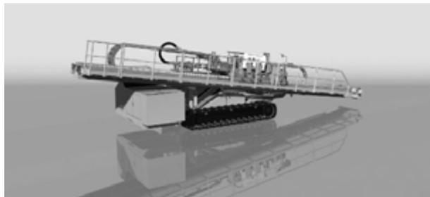
图3 海瑞克履带式钻机示意图
